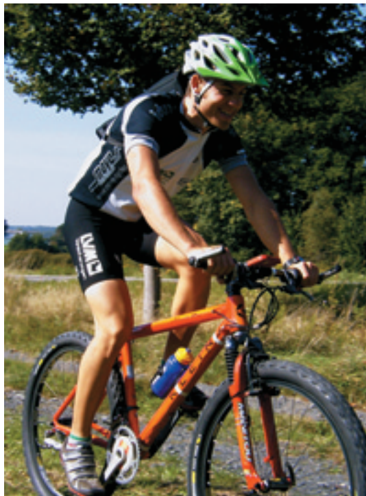
Abb. 2: Untersuchungsrad mit Systemgewichtsausgleich durch Trinkflasche und Rucksack.
